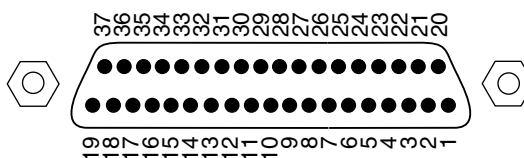
Connecteur SUB-D 37 broches (repérage vu côté des broches mâles)
