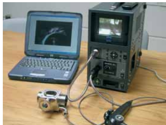
Endoscopie de la surface et des soudures internes des vannes
