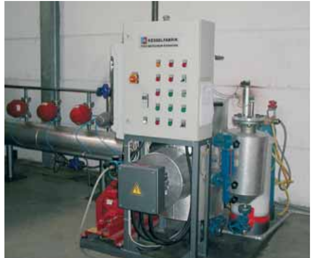
Banc d'essais pour simulation de stérilisation. Test des vannes et des membranes à la vapeur saturée.
