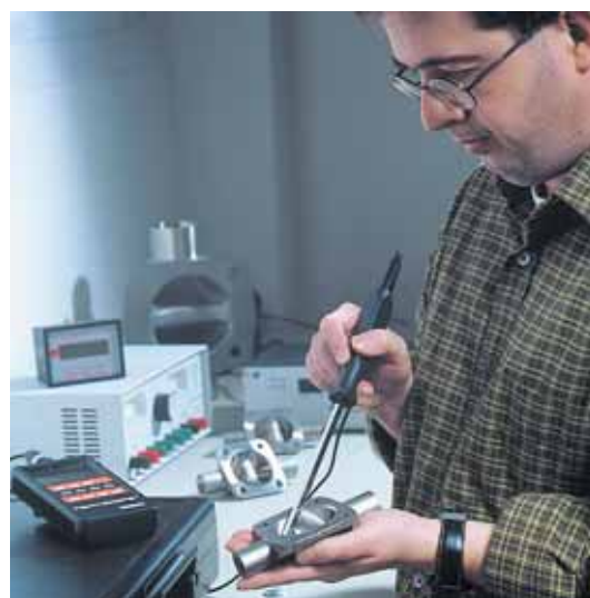
Mesure du taux de ferrite d'un corps de vanne en acier inox
